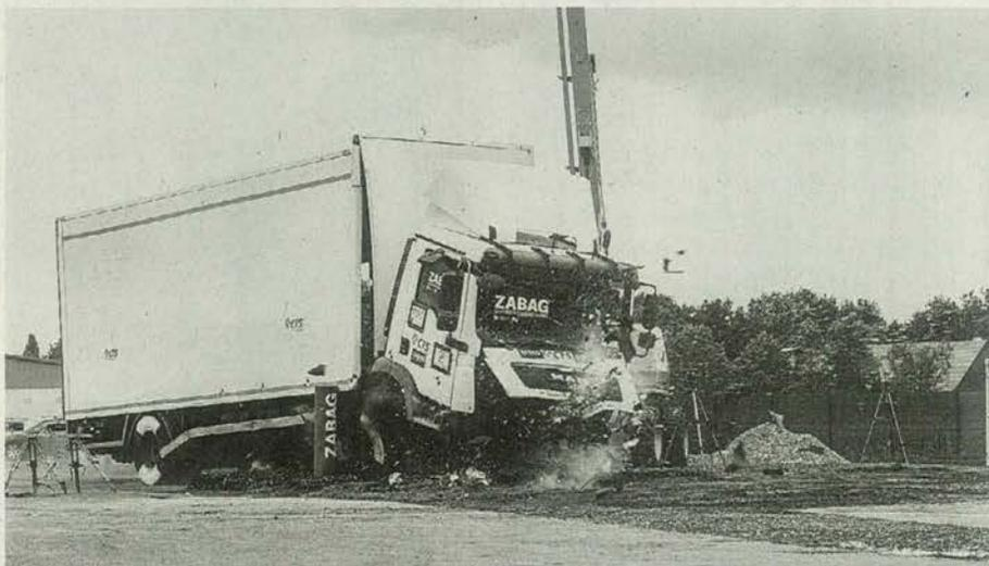
Die neuen Poller des Typs Z-HFFP 273, die eine Sperrhöhe von 1100 mm aufweisen, konnten von dem Lkw weder überwunden noch aus dem Boden herausgerissen werden. FOTO: ZABAG
