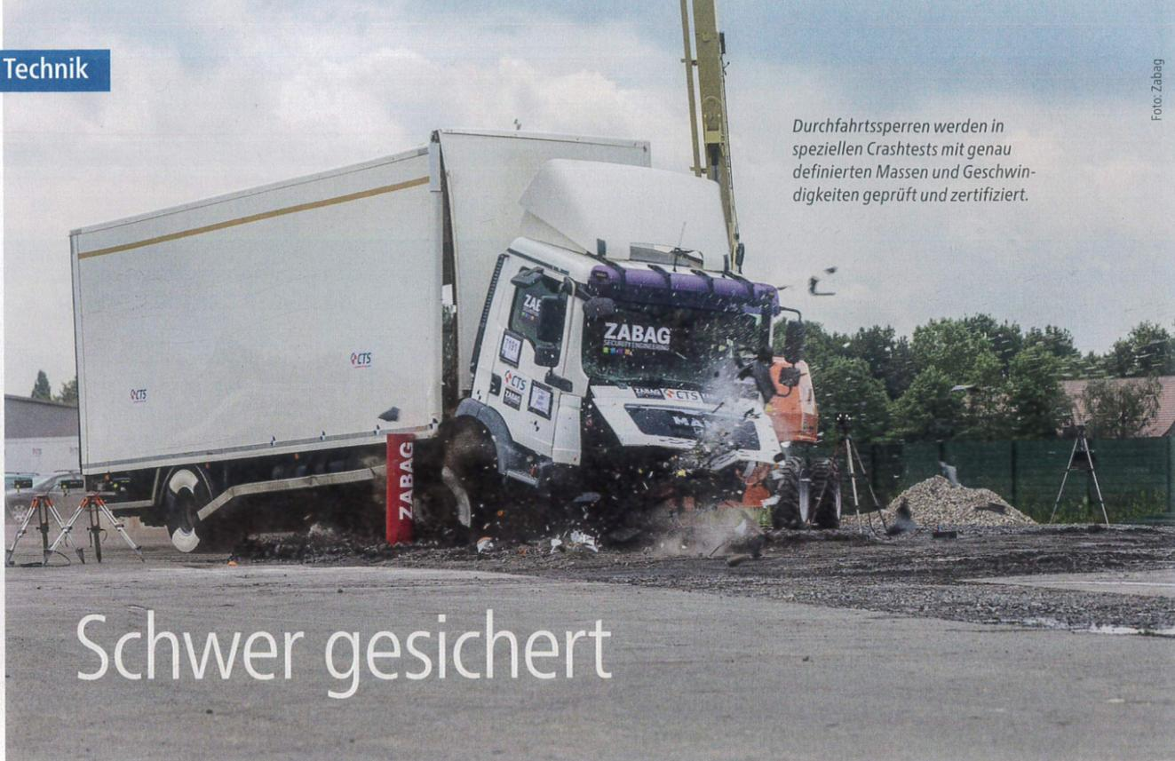
Durchfahrtssperren werden in speziellen Crashtests mit genau definierten Massen und Geschwindigkeiten geprüft und zertifiziert.
