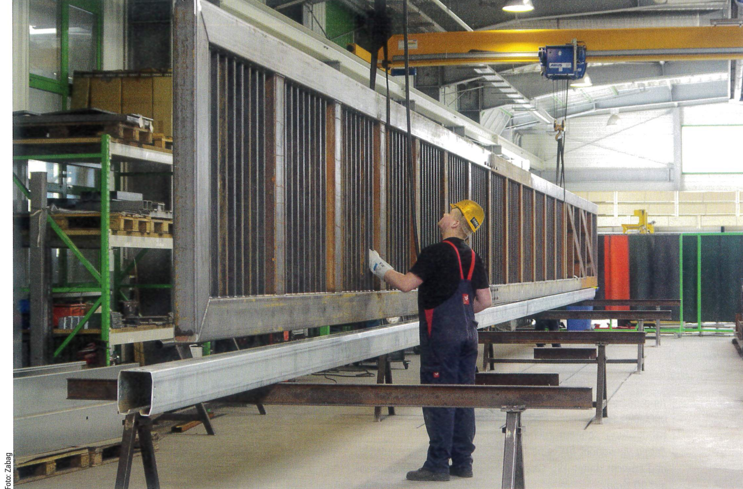
Imposanter Metallbau: ein 19 Meter langes, freitragendes Schiebetor.
